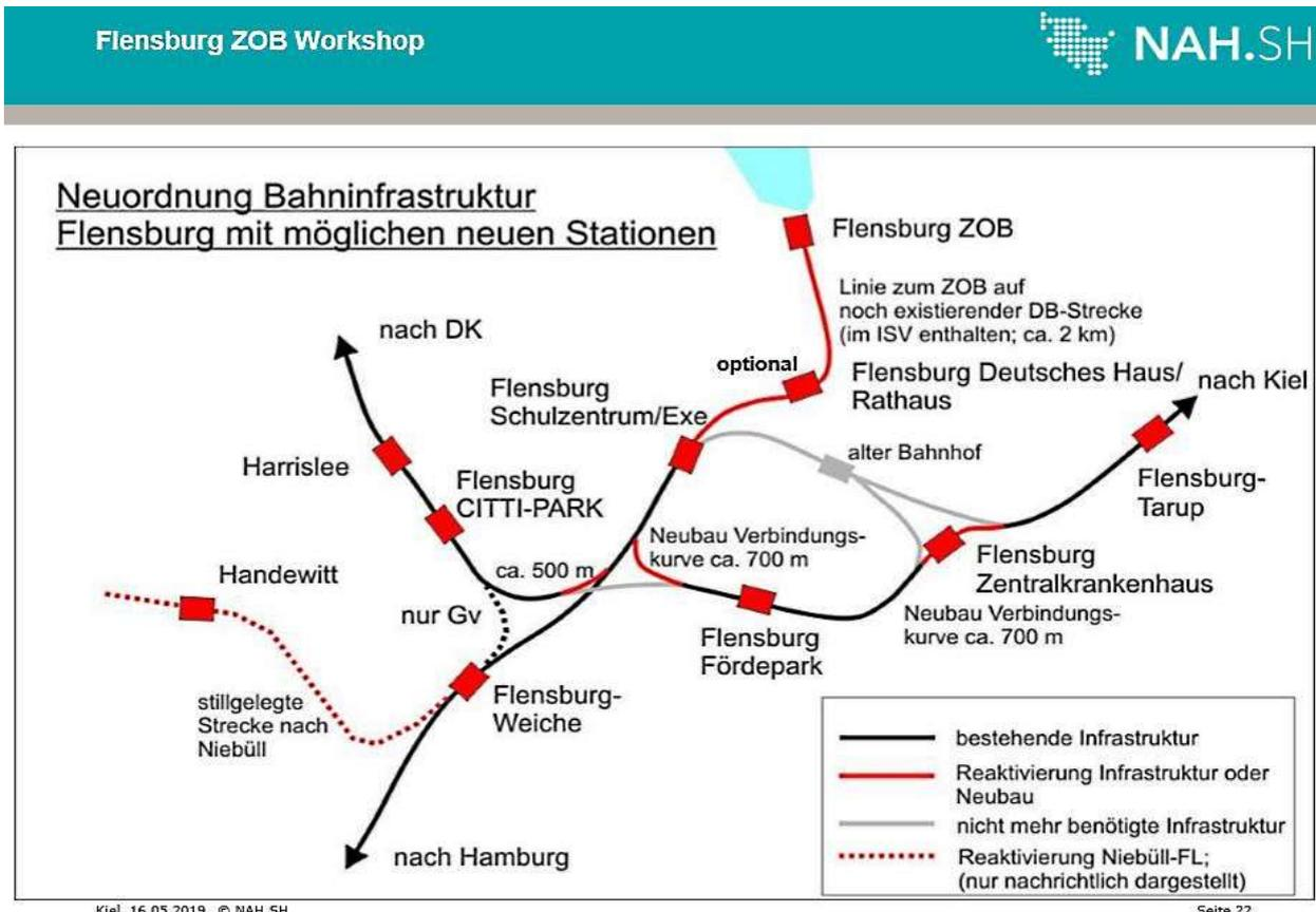
Schaubild 4: Das bestehende Bahnnetz ist gerade durch die Schleifen gut erweiterungsfähig.
